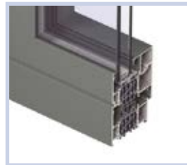
Reynaers CS86-HI stavebná hĺbka rámu: 77 mm počet komôr: 3 počet tesnení: 2 U_f \geq 1,2
