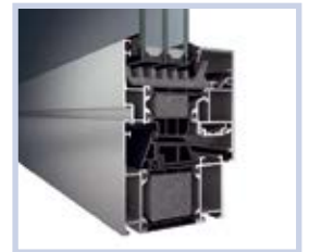
Schüco AWS 75 SI stavebná hĺbka rámu: 75 mm počet komôr: 3 počet tesnení: 2 U_f \geq 0,9
