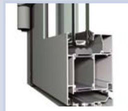
Reynaers CS86-HI stavebná hĺbka rámu: 77 mm počet komôr: 3 počet tesnení: 2
